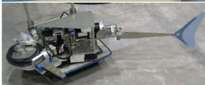
シノメサカタザメ型ロボットとその内部構造
